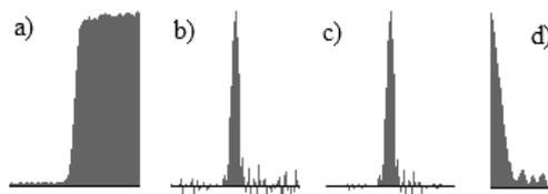
Fig. 3. (a) ESF, (b) LSF, (c) Hamming LSF, (d) MTF plots
