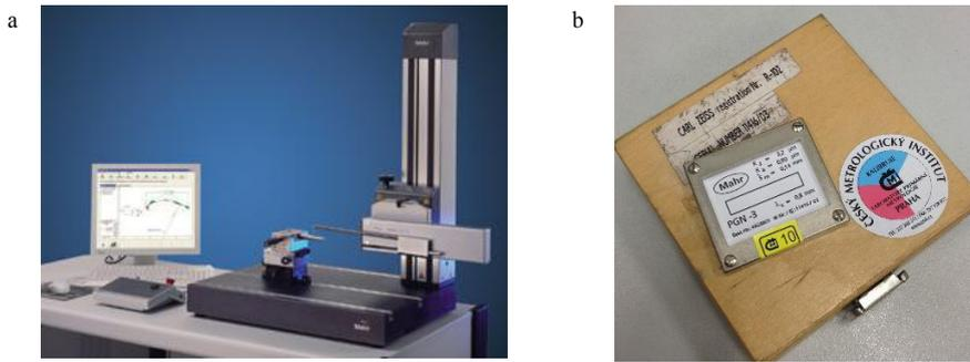
Fig. 3. (a) MAHR MarSurf XCR 20, (b) Caliber MAHR W-Nr: 11416/03.
