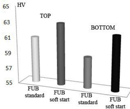
Fig. 22. Hardness test values for FUB.
